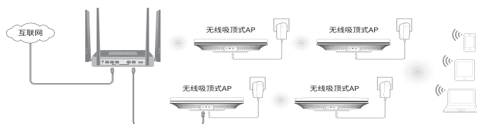
图5-2 开启设备集中管理功能的组网拓扑（二）
